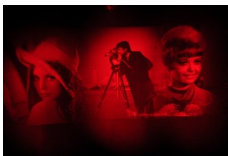
図2 高速2値位相変調素子を用いた画像拡大実験結果.
