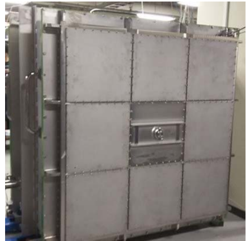
図 2 感度向上のために大型化(約 1\text{m}^3 )した制作中の次期 NewAge 検出器。
