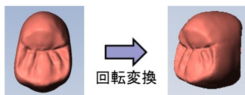
加工後の削り残しが最小となる加工姿勢 ⇒ モデルの投影面積が大きくなる姿勢
